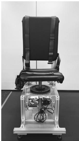
図2 体幹回旋力測定台
